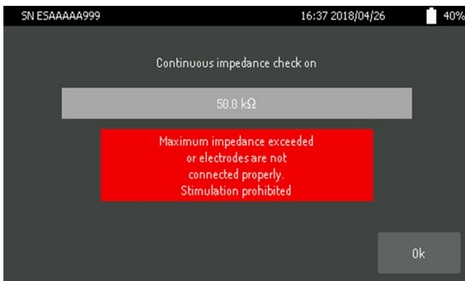
Rysunek 60. Osiągnięto maksymalny poziom impedancji. Oba komunikaty ostrzegawcze są wyświetlane na czerwono.
