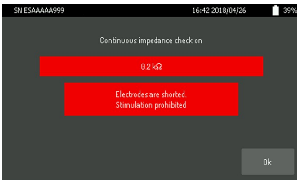
Rysunek 61. Wykryto zwarcie - pasek impedancji pokazany na czerwono z określonym komunikatem ostrzegawczym.
