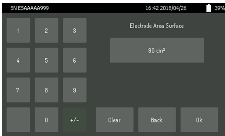
Rysunek 41. Ustawianie pola powierzchni elektrody o nieustalonym kształcie.
