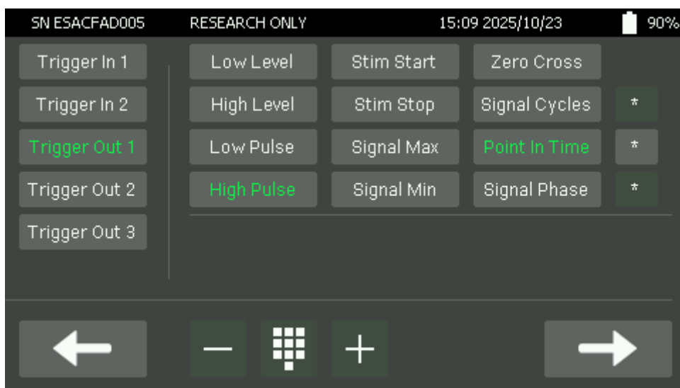
Rysunek 99. Ekran ustawień triggera wyjściowego dla trybu tACS. W trybie tACS dla sygnału wyjściowego typu Low/High Pulse dostępne są wszystkie rodzaje zdarzeń wywołujących sygnał sterujący.
