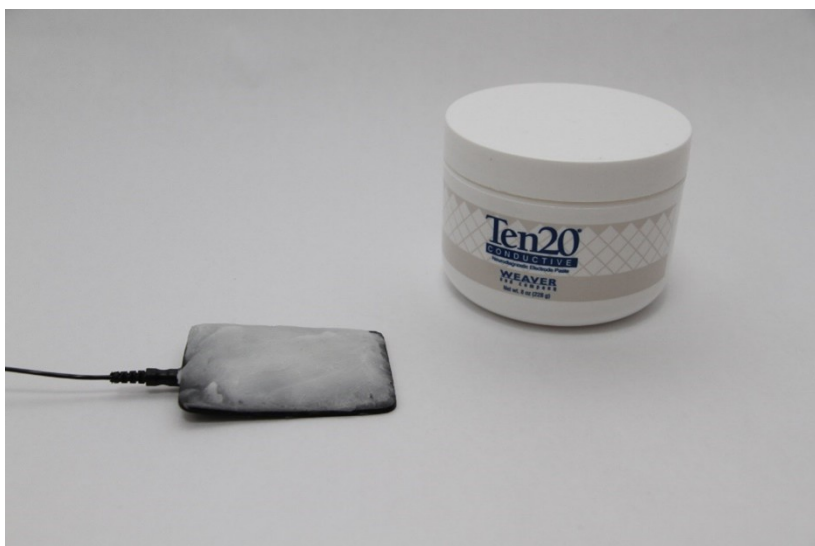
Rysunek 9. Elektroda gumowa z nałożonym żelem przewodzącym.
