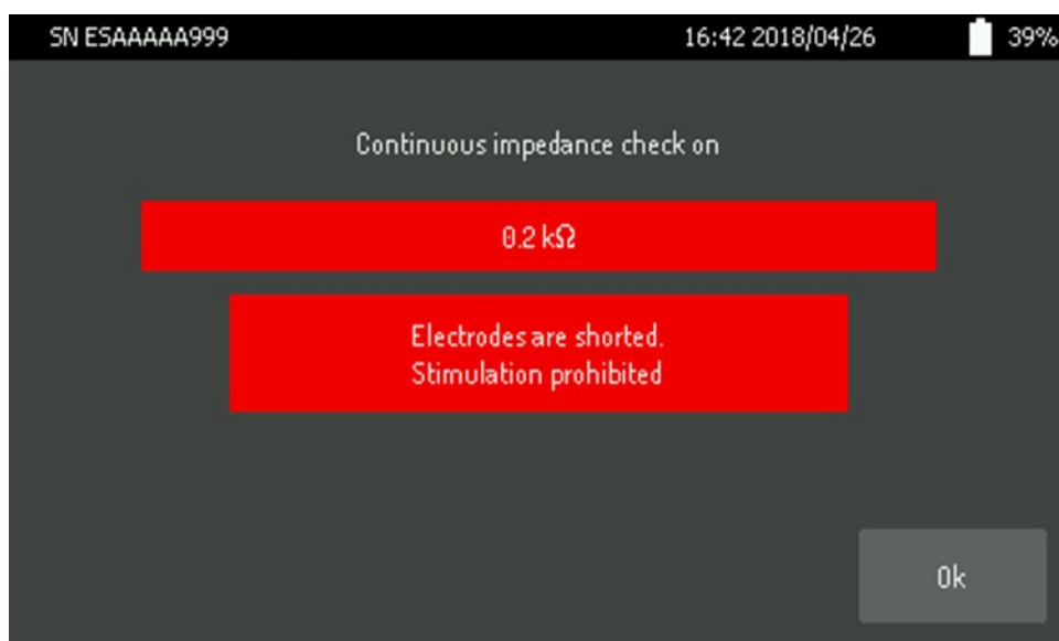
Rysunek 64. Wykryto zwarcie - pasek impedancji pokazany na czerwono z określonym komunikatem ostrzegawczym.
