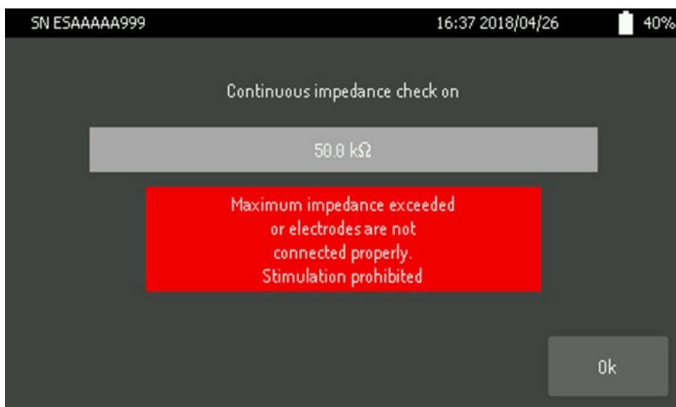
Rysunek 63. Osiągnięto maksymalny poziom impedancji. Oba komunikaty ostrzegawcze są wyświetlane na czerwono.
